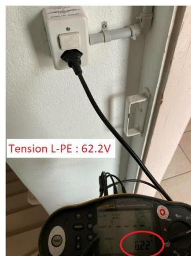
3. Inversion des conducteurs de phase et de neutre avec mise sous tension des parties métalliques, cela vient souvent de la confusion avec l'ancien conducteur de phase bleu et le nouveau neutre bleu.
